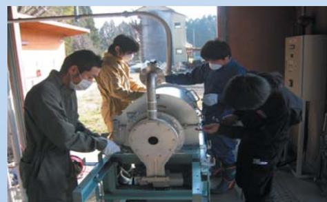
ベンチスケール炉による混合燃料の燃焼実験
