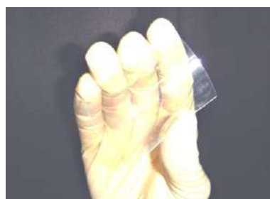
写真1 フレキシブル透明電極 (樹皮(PET)基板)
