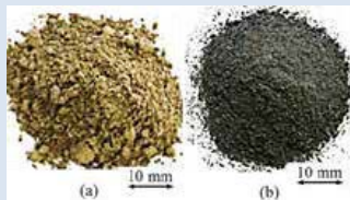
▲原材料、(左) 宮崎県産の粘土、 (右) 粉砕した GFRP ↓ 900℃~1200℃
